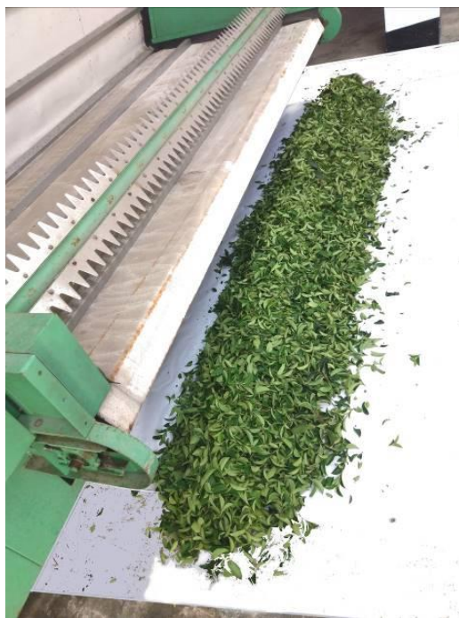
圖五、茶菁攪拌完成後出料
