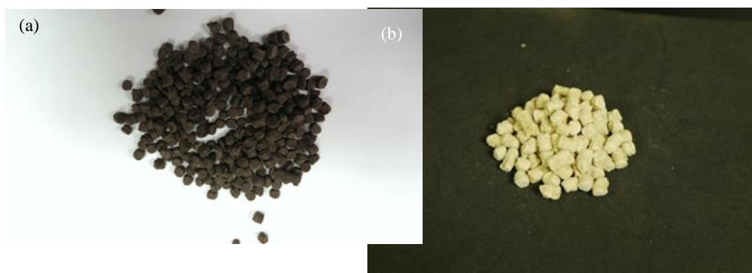
圖二、(a) 紅茶粉 / rHDPE 塑粒 (b) SPF 木粉 / rHDPE 塑粒
