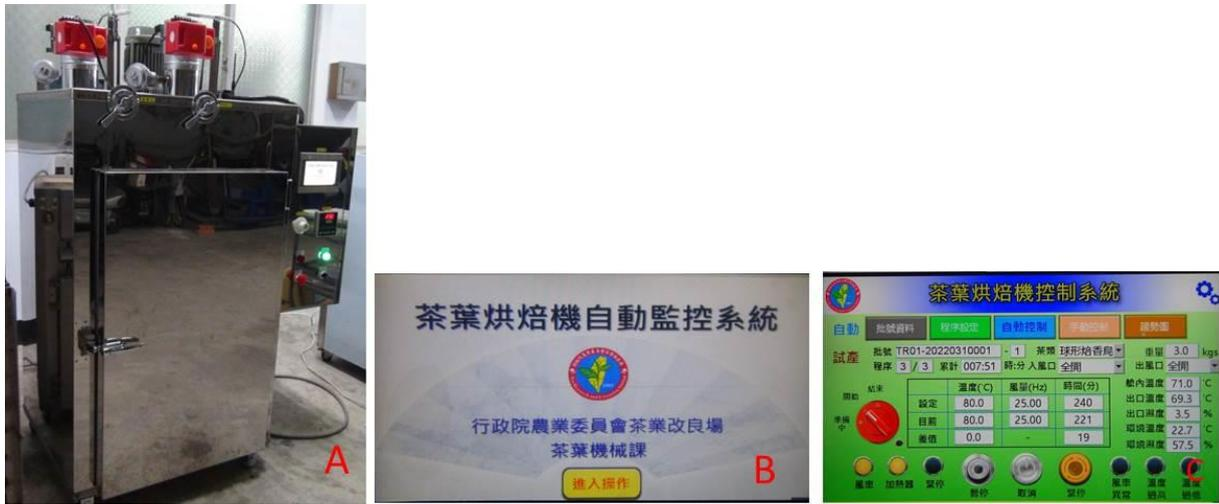
圖一、具有監控系統之茶葉烘焙機
