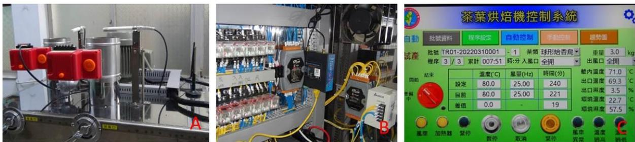
圖二、烘焙機監控系統
