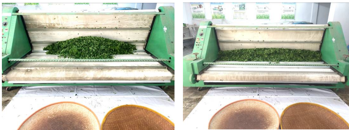
圖四、由中央倒入之茶菁，經攪拌後可自動均勻分散
