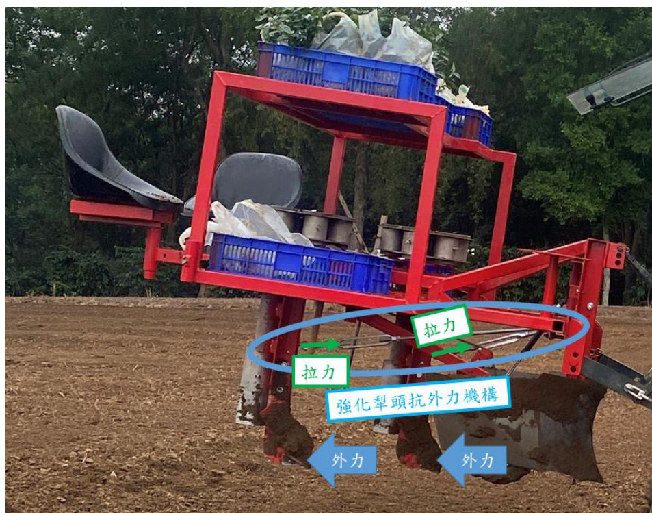
圖十、下一代植茶機強化主體機構
