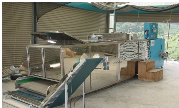
圖一、三層式輸送帶之熱風萎凋兼乾燥機
