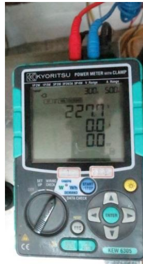
圖六、功率計 (型號：KEW 6305) Fig. 6. Power meter (model : KEW 6305)
