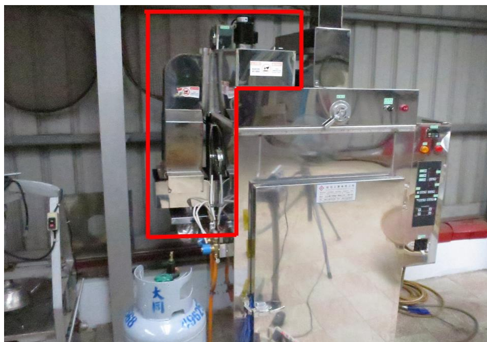
圖十五、燃燒爐與熱交換器外側需要覆蓋隔熱棉
