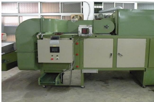
圖六、改良型連續式茶葉乾燥機
