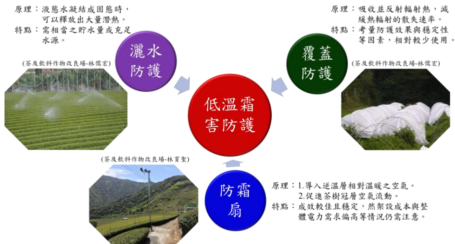
圖1、茶園低溫霜害物理性防護方式整理
