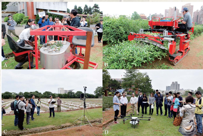
圖二、智能省工機械操作展示情形。(A) 自動種茶機；(B) 乘坐式採茶機； (C) 環境參數自動感測記錄模組；(D) 無人噴藥機
