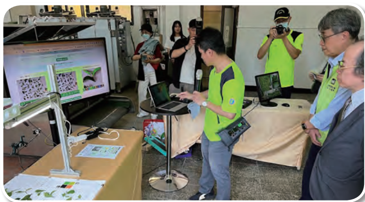
圖七、智慧製茶生產線前端藉由影像辨識茶菁老嫩度，據以作為自動生產線之基礎。
